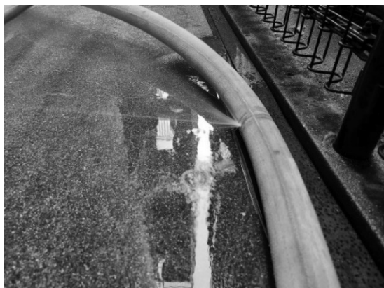
ホースの破損による漏水
