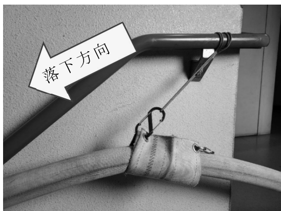
落下側のカラビナにパワーロープを取り付けると、摩擦でホースが動かない
